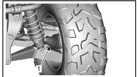
ЗАДНЯЯ ЧАСТЬ МОТОВЕЗДЕХОДА 1. Чехол наружного шарнира приводного вала
